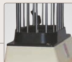
Separatore per consentire il taglio di 2 baguette alla volta
