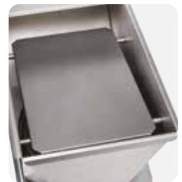
Tramoggia automatica con capacità fino a 1500 Kg/h (25 kg/min.)
